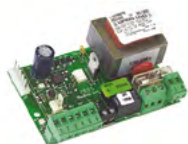
Плата управління 540 BPR (вмонтована в привід)
